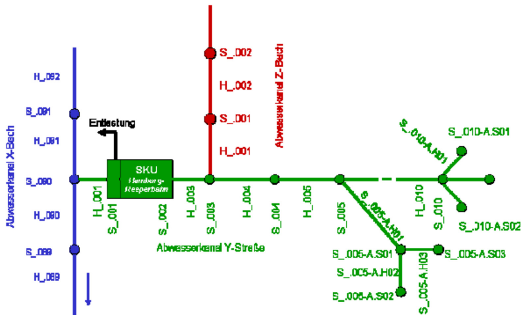
Abbildung 20: Schematische Darstellung eines Kanalnetzes mit Haltungen und Schächten.
