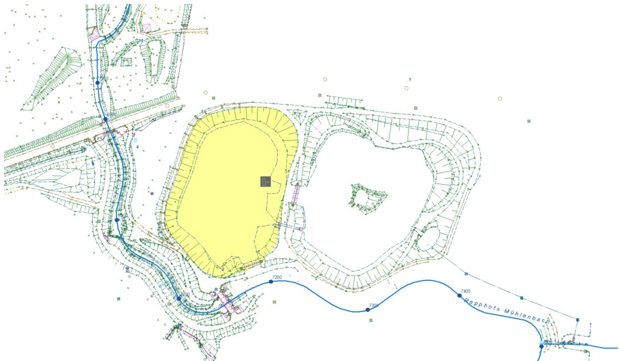
Abbildung 37: Hochwasserrückhaltebecken mit zugehöriger Bauwerksfläche
